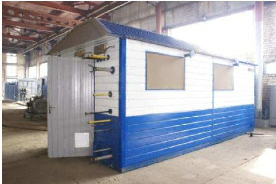
Рис 2. Блок одоризации индивидуального исполнения
